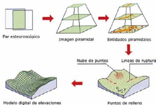
Figura 20 Esquema obtención MDT
