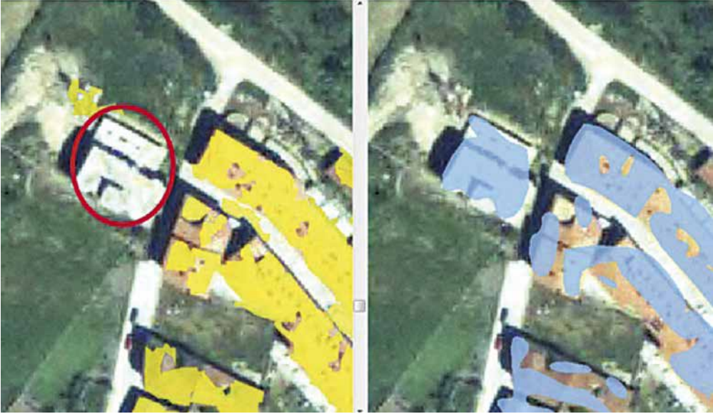
Figura 18 Edificaciones que no se detectan con Imagine Objective y sí con LiDAR
