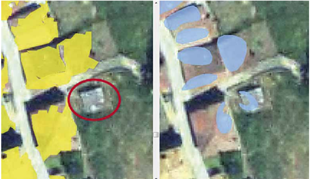
Figura 20 Edificaciones no incluidas en la BD catastral detectadas por LIDAR y no por Objective
