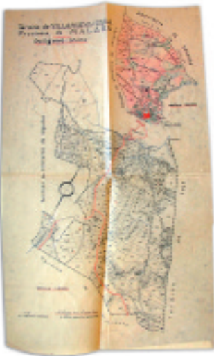
Figuras 12 y 13: Plano topográfico parcelario de Villanueva de Tapia (Málaga) de 1944 (AHPMA) y Parcelario retintado de Lleida de 1954 (AHPL). La Orden Ministerial de 16 de diciembre de 1941 plantea dos operaciones catastrales distintas: la conservación de los avances catastrales y la elaboración de un catastro parcelario donde se hubiera desarrollado la primera etapa del modelo, como es el caso de la provincia de Málaga, y la formación de nuevos catastros mediante fotografía aérea.
