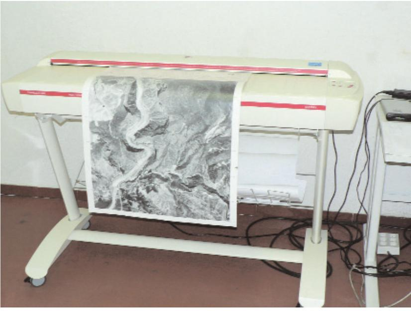
ba abajo, éste tiene fijos los sensores y desplaza el original. Los grosores admitidos van desde pocas décimas de milímetro a 15 mm.
