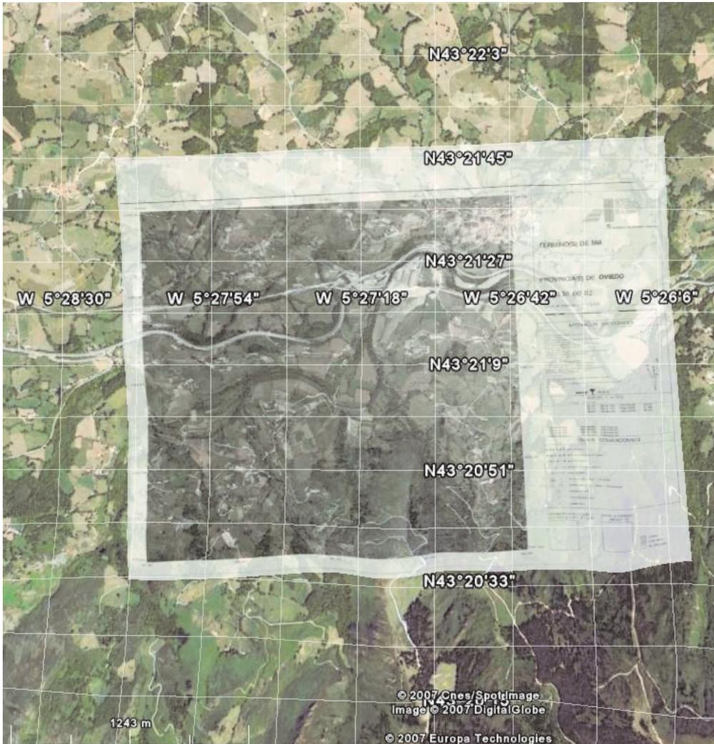
El paso siguiente es colocar de forma automática la imagen digital de la ortofoto seleccionada. Al estar georreferenciada, se coloca exactamente en las coordenadas correspondiente del terreno.
