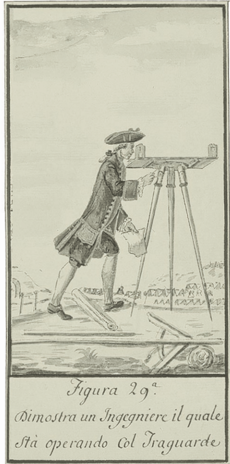
Ingeniero militar trabajando en la medición del terreno y levantamiento de su plano (Alfonso Trocoli, Teatro Militare dell'Europa, Biblioteca del Palacio Real de Madrid).
