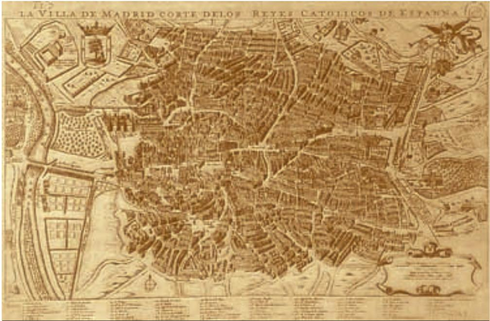
de la manzana. La escala de trabajo referenciada en pies castellanos es de 1:267, lo que permite una medición y deslindes de precisión, válidos para los fines catastrales perseguidos. Como veremos al final de la exposición esta precisión ha sido contrastada mediante superposición con el Catastro actual.
